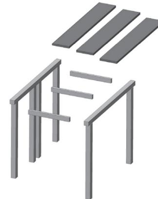
3. Поверх собранного каркаса укладывают три площадки 1800x300 мм, одна из которых имеет скругление по торцу и является лицевой (поз. 1 и 2). Фиксируются площадки к каркасу снизу, с помощью металлических уголков и саморезов 3,5x35 мм.
