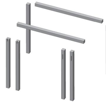
2. Между собой конструкции соединяются стяжками 720 x 80 (поз. 5), которые крепятся саморезами 3,5 x150 мм. Две стяжки по краям конструкций, одна - по центру.
