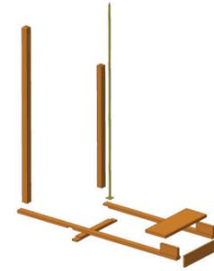
2. На углу более длинного основания устанавливают столб (поз. 7). На более короткой части основания закрепляют круглый металлический столб (поз. 4).
