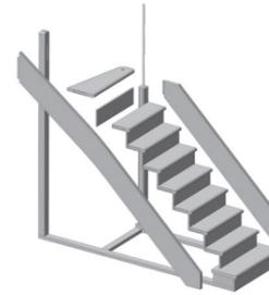
4. В пазы углового и центрального столбов заводят соответственно среднюю и нижнюю деревянную струны(поз. 10 и 11), закрепив их саморезами 3,5х70 мм.
