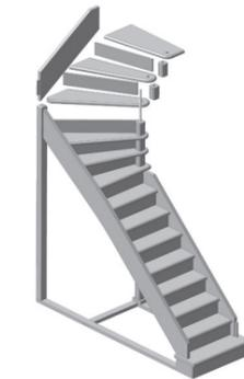
6. Начиная со ступени №9 (поз. 17) ступени имеют круглое отверстие, предназначенное для круглого металлического столба. Ступени (поз. 17-22) заводят на столб чередуя с муфтами (поз. 15, 5 шт). Свободные концы ступеней крепят к струне через металлический уголок саморезами 3,5х35 мм. Между ступенями закрепляют подступени (поз. 23-26).
